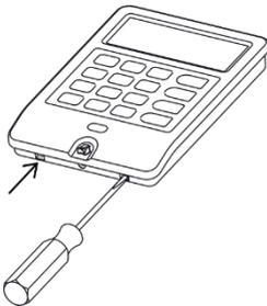
Fig. 2. Manera de abrir la carcasa
